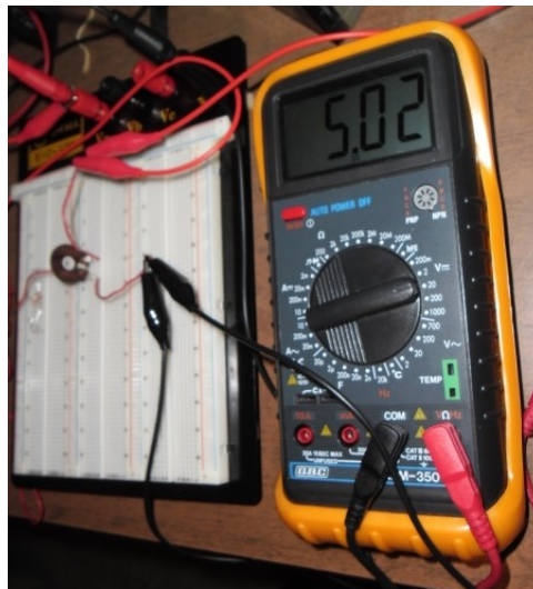
Figura 8 Misura della tensione di alimentazione.
