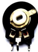
Figura 2 La levetta per regolare la resistenza.
