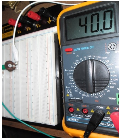
Figura 5 La misura di una resistenza del potenziometro.
