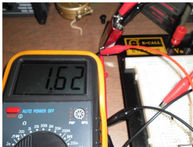
Figura 9 La tensione ai capi del resistore da 1kOhm.
