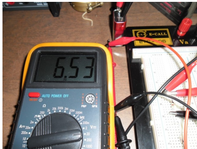
Figura 8 La tensione ai capi del resistore da 3.9kOhm.
