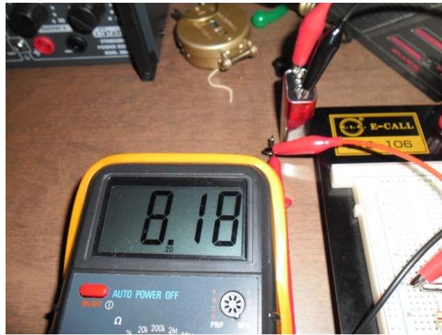
Figura 7 Misura della tensione ai capi della serie.
