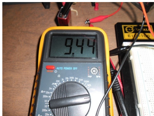
Figura 5 Misura della tensione della batteria.
