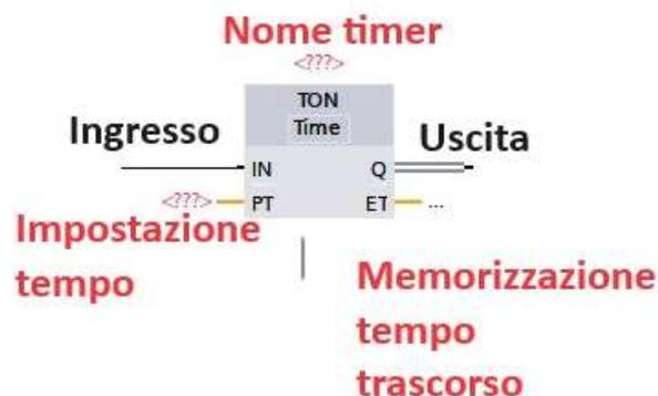
Merita un approfondimento il PIN ET (Elapsed Time) che può anche non essere utilizzato ma, se lo associamo ad un merker di tipo double word, siamo in grado di memorizzare il tempo trascorso.
